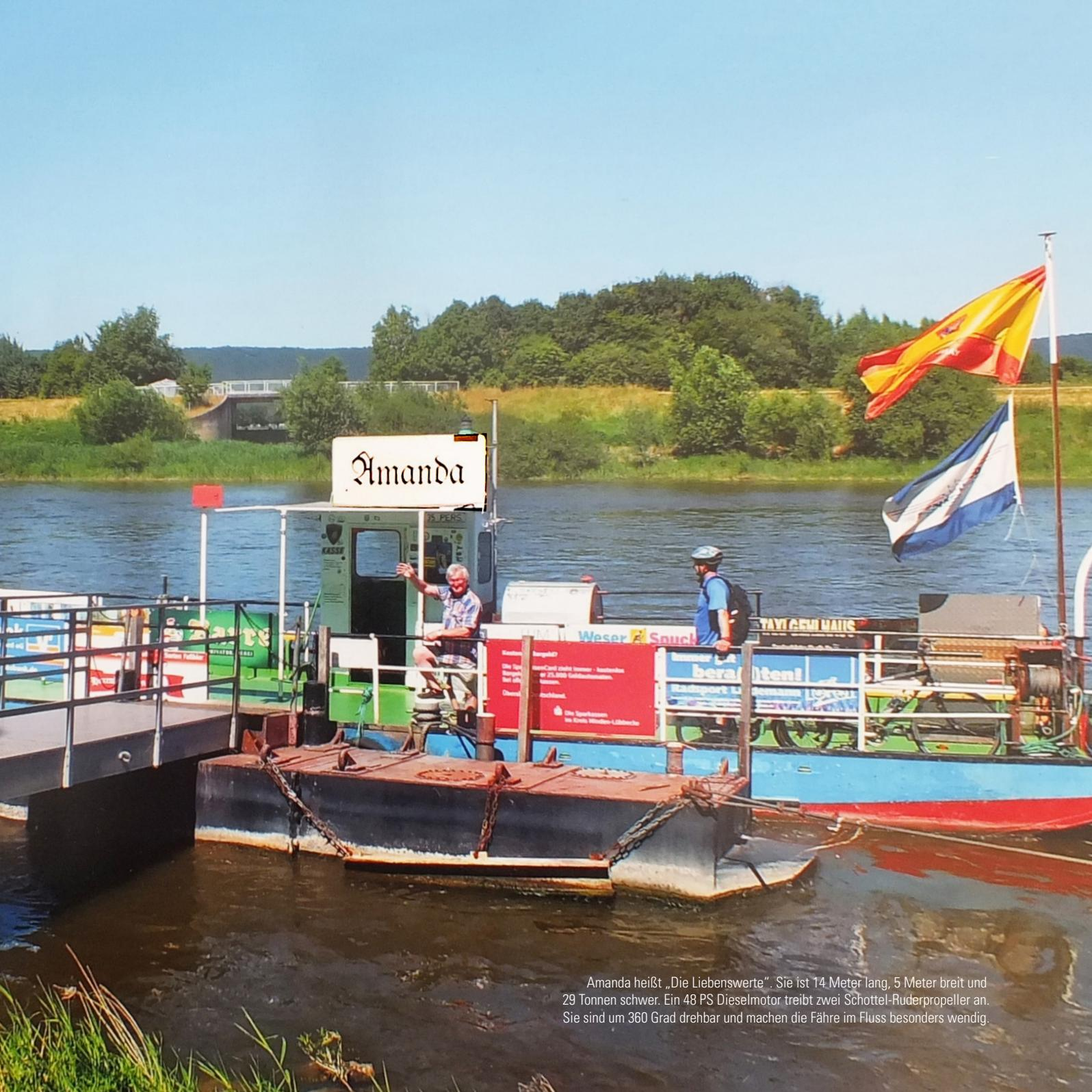
Amanda heißt „Die Liebenswerte“. Sie ist 14 Meter lang, 5 Meter breit und 29 Tonnen schwer. Ein 48 PS Dieselmotor treibt zwei Schottel-Ruderpropeller an. Sie sind um 360 Grad drehbar und machen die Fähre im Fluss besonders wendig.
